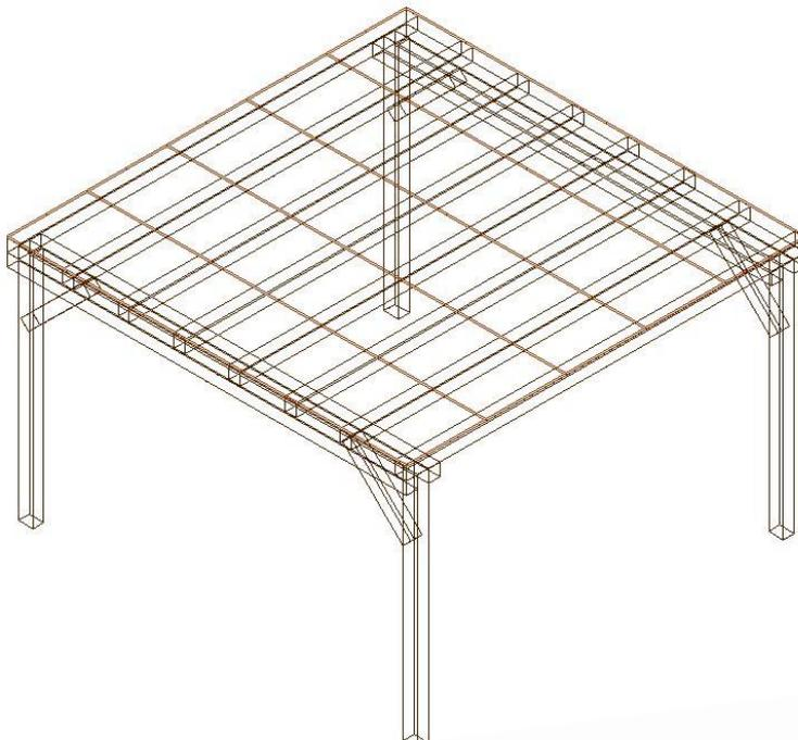
Grundkonstruktion von 5m x 5m x 3m
